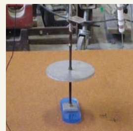
「足元の安定性からみた床のかたさ」試験試験装置の一部(アタッチメント部分[写真])
