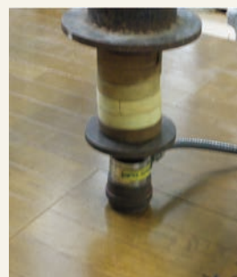
「歩行時を代表とするの床のかたさ」試験 試験装置の一部(アタッチメント部分[写真])
